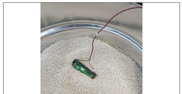
Test einer 18650-LIA Zelle Eigene Darstellung
