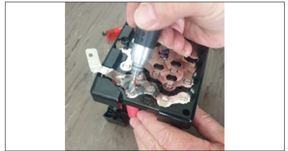
Demontage eines LIA-Packs Eigene Darstellung
