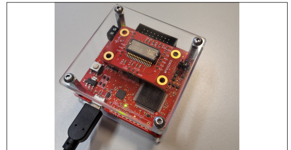
Murata MEMS-Sensor (SCHA63T-K03) auf Evaluation Unit Eigene Darstellung
