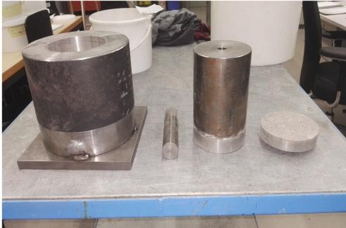
Einzelteile der Versuchsanordnung für die Simulation der Gutbettwalzenmühle
