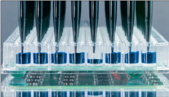
Unterschiedlicher Füllstand (übertrieben dargestellt)
