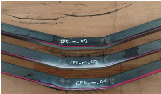
Hohlprofile 50x50x2.9x1800 mm mit geklebten CFK-Lamellen 50x1.4x1000 mm Baschung, Bachelorarbeit FS20
