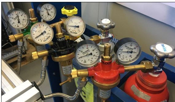
Abbildung 2: Die Edukte Wasserstoff und Kohlenstoffdioxid in Gasflaschen.
