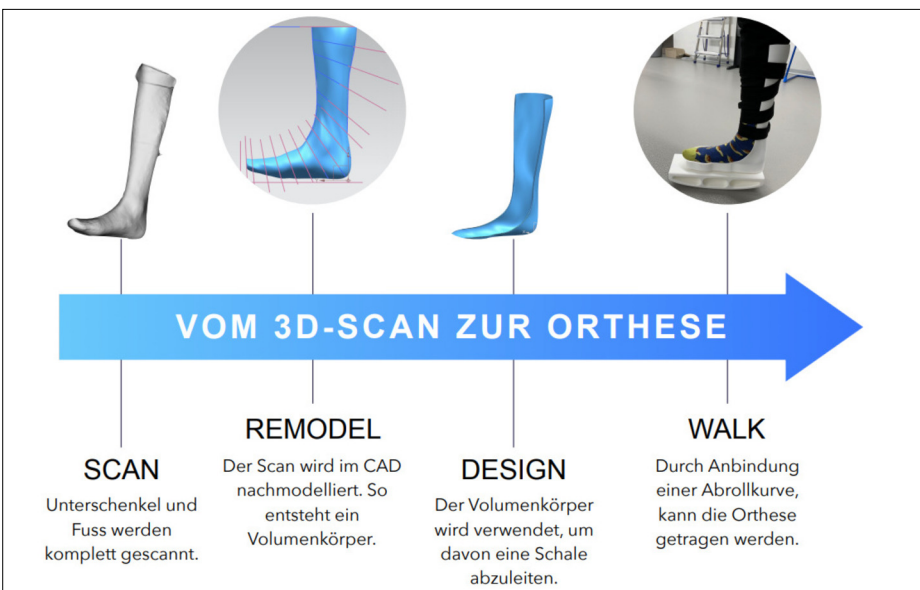
Prozess; Vom 3D-Scan zur Orthese Eigene Darstellung
