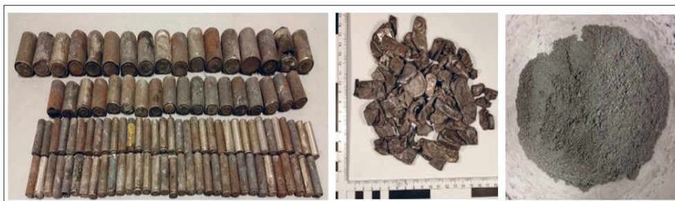
Batterien aus dem Feineisenschrott (links); Batterie-Stahlmäntel nach dem Schreddern (Mitte); feinkörniger zinkhaltiger Batterieinhalt (rechts).
