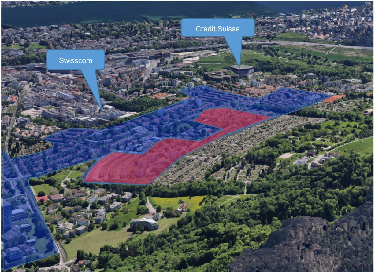
Abbildung 2: Gebiet der Familienheimgenossenschaft Zürich, welches bis 2030 mit einem „Anergienetz“ versorgt werden soll (rot: bereits realisiert). Die Abwärme stammt hauptsächlich aus zwei Rechenzentren. Quelle: Google Earth
