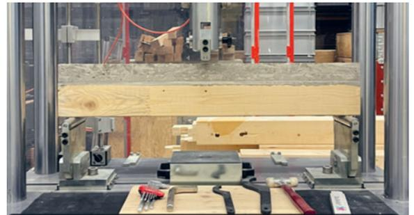
Abbildung 2: Biegebruch im Holz
