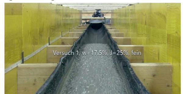
**Auswertung: Frontgeschwindigkeit der Versuchsreihe mit Wassergehalt 17,5%, Neigung 25% und beider Kornverteilungen**
