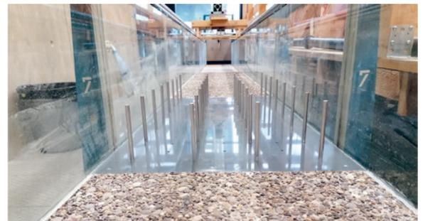
**Darstellung Messung Versuchsrinne und Berechnung BASEMENTv3, Neigung der Versuchsrinne 1,125%**
