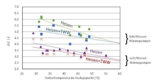
Diese Grafik zeigt die Effizienz von Wärmepumpenanlagen im Feld, die das Wärmepumpen-Testzentrum WPZ im Auftrag von Energie Schweiz untersucht hat. Zu sehen ist die Jahresarbeitszahl (JAZ) in Abhängigkeit zur Vorlauftemperatur im Auslegepunkt bei Luft/Wasser und Sole/Wasser Wärmepumpen im reinen Heizbetreib oder im kombinierter Heiz- und Trinkwarmwasserbetrieb.
