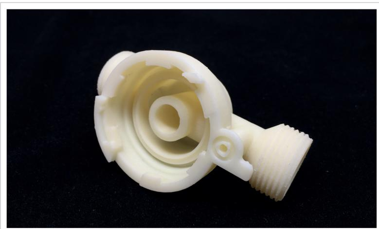
3 | ABS-Bauteil nach rückstandslosem Auswaschen der Stütze
