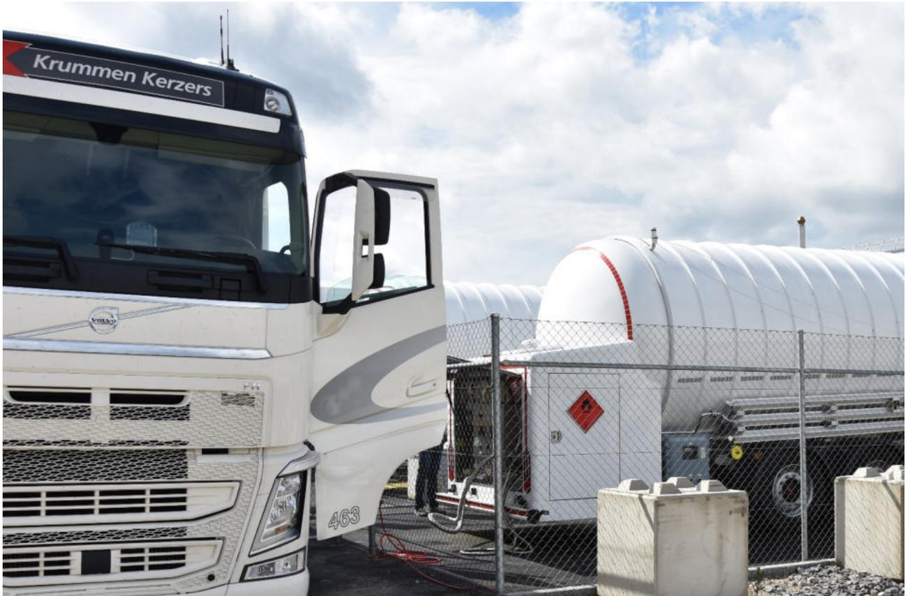
Abbildung 16: Tankstelle in Sévaz mit Lkw beim Betankungsvorgang. Im Hintergrund der LNG-Trailer, welcher die Tankstelle mit LNG beliefert.
