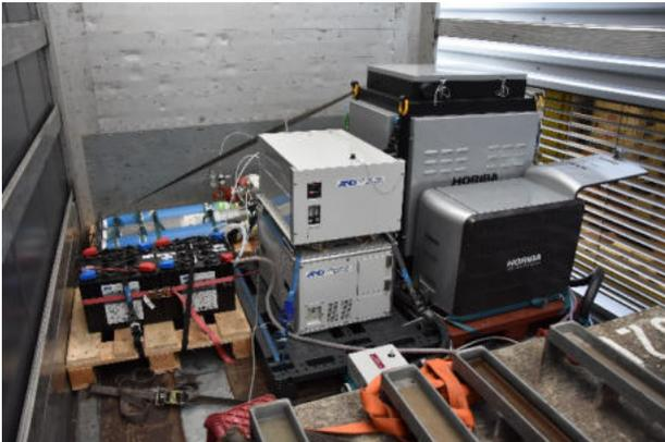
Abbildung 19: Aufbau Messequipment der Abgasprüfstelle der Berner Fachhochschule in Nidau.
