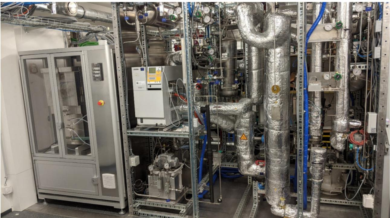
Abbildung 43: Blick ins Innere der Anlage mit provisorisch aufgebauten HT-Elektrolyse (links) und Methanisierungsreaktor (rechts) (Januar 2020).
