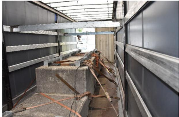
Abbildung 20: Montierte Gewichte im Auflieger der Lkw für die genaue Kenntnis der transportierten Last.
