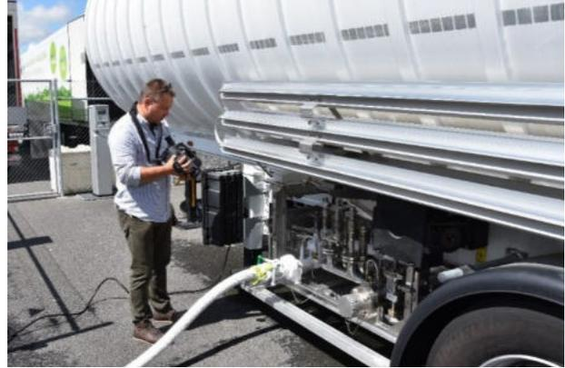
Abbildung 18: Überprüfung der Befüllung der Tankstelle auf Leckage mit einer Gascam durch die Itema GmbH.
