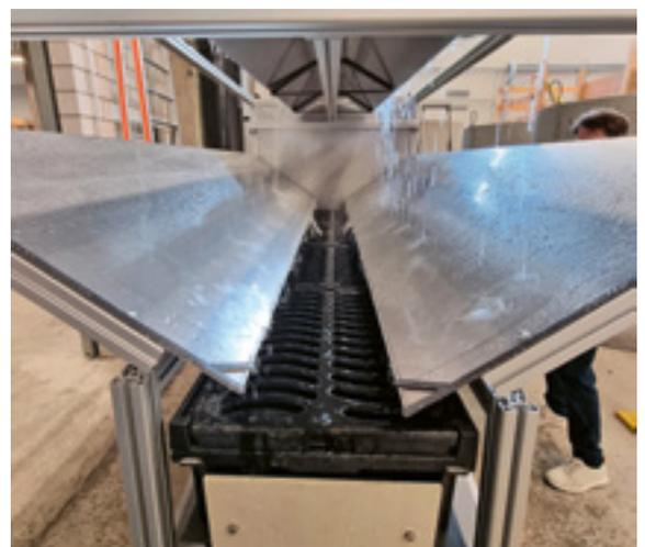
Das UMTEC prüfte sechs technische Behandlungsanlagen (vier Schacht- und zwei Rinnensysteme, rechts) mittels simulierten Feldtests. Dabei wurde die hydraulische und stoffliche Leistungsfähigkeit für GUS, Schwermetalle und Mikroverunreinigungen bestimmt. Die hydraulische Beschickung basiert auf drei verschiedenen Prüfregenspenden: Starkregen, Landregen, Kleinregen. Für die frachtgemittelte Bewertung wurden rund 40 Ereignisse einbezogen.
