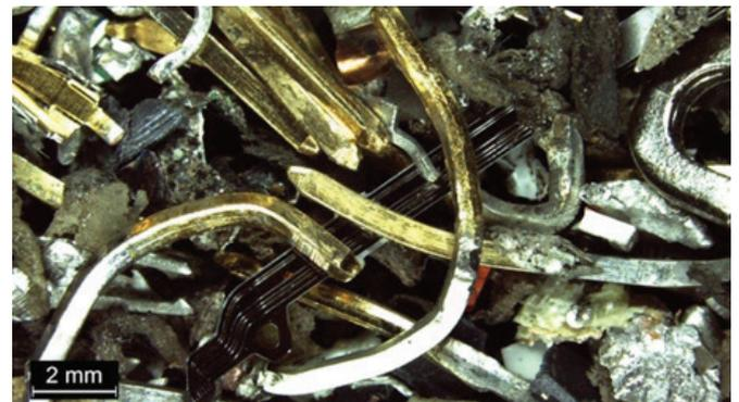
Abb. 4: Schwach magnetische Fraktion des Shredderguts, 1-2mm.
