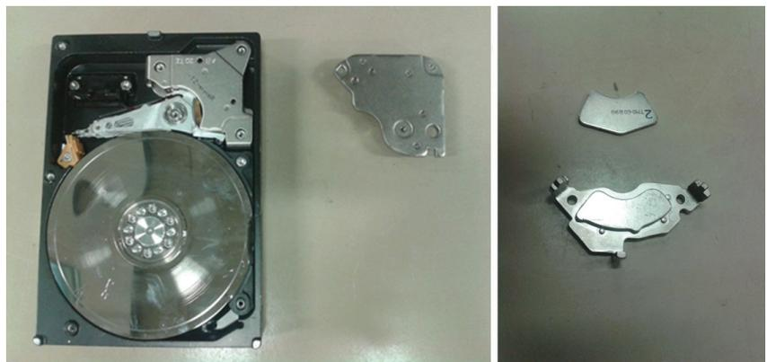
Abb. 1: Die linke Abbildung zeigt eine aufgeschraubte Hard Disk und die aus Neodym-Magneten bestehende Halterung des Schreibfingers. In der rechten Abbildung sind Neodym-Magnete ohne (oben) und mit Halterung (unten) dargestellt.
