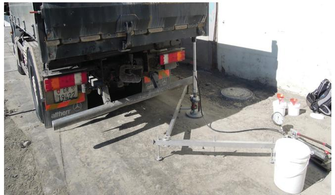
Abb. 5: Festigkeitsmessungen (ME-Wert) nach Aushärtung der Prüffelder im grossen Feldversuch
