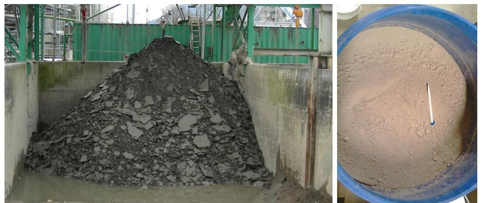
Abb.1: Das Ausgangsmaterial: Kiesschlamm (links) und Holzasche aus der Verbrennung von unbehandelten Holzabfällen (rechts).
