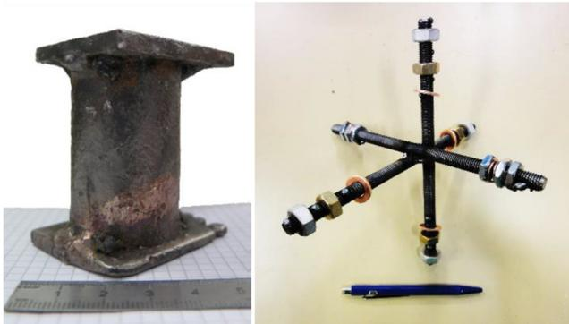
Abb. 2: (links) Prüfkörper Serie A: Probenbehälter in welchem Indikatormetalle mit bekannten Schmelzpunkten in Sand eingelagert waren (Photo: Probenbehälter nach Rückgewinnung aus der Schlacke).
