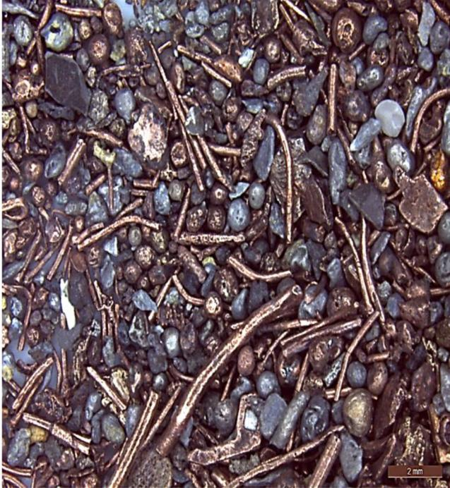
Abb. 6: Intakte Kupferdrähte im Gemisch mit geschmolzenen Kupferdrähten, die sich zu Kügelchen zusammengezogen haben.
