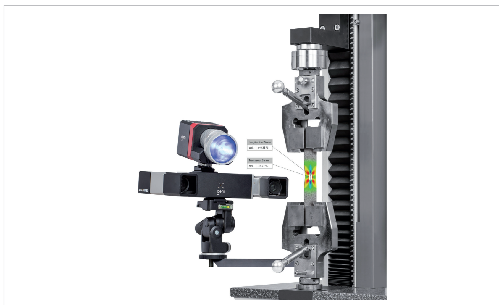
1 | Schema des Versuchsaufbaus mit dem ARAMIS GOM
