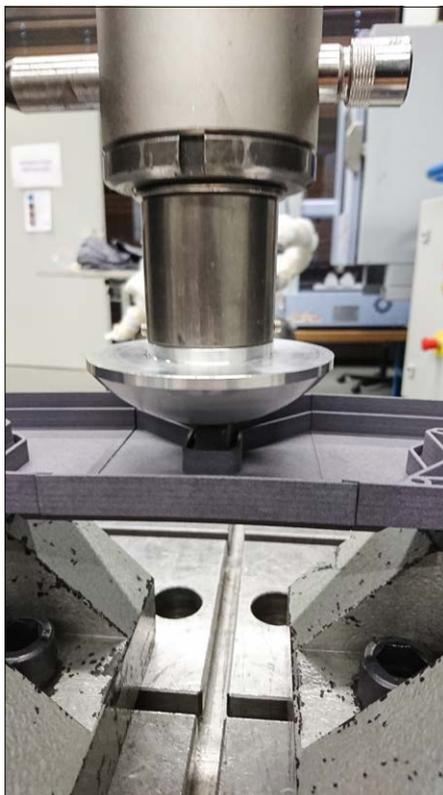
Dreipunktbiegeversuch von einem mit Ultraschallschweissen verbundenen Bauteil.
