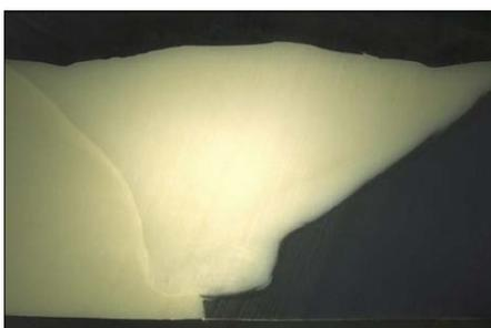
Bild 6: Schlibfbild der Schweissversuche mit statischem Schuh
