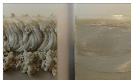
Bild 7: Vergleich einer Schweissnaht, erstellt mit einer rotierenden Schulter (rechts) und einem stehenden Schuh (links)
