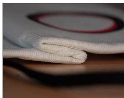
Bild 3: Die reaktive Schmelzklebefolie hält die gefaltete Atemschutzmaske für einen optimalen Tragekomfort zusammen (Semesterarbeit S. Deola HS 20)
