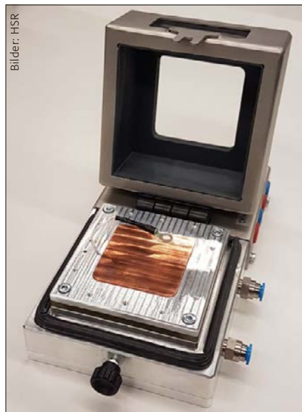
Bild 1: Temperierkammer zur Messung des Wärmeausdehnungskoeffizienten [2]
