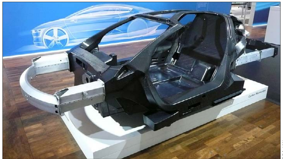
Bild 4: Karosserie aus einer Multi-Material-Kombination [4]
