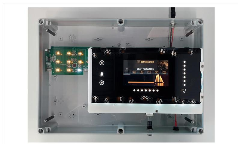
3 | Demonstrator eines HMI für Haushaltsgeräte
