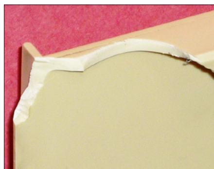
Bild 1: Gleichsinnig räumliche Spannungszustände, insbesondere an Stellen hoher Spannungs-konzentration, können zu Sprödbbruchverhalten führen.
