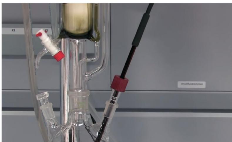
2 | Soxhlet-Extraktion eines weich-gemachten PA12 mit Lösungsmittel zur Ermittlung des Weichmachergehaltes
