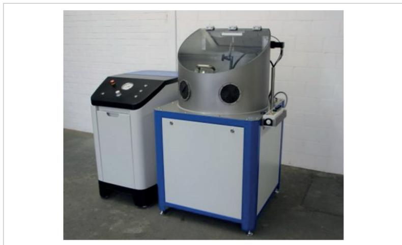
1 | Surfast®-Anlage mit Bearbeitungsdruck bis zu 150 bar
