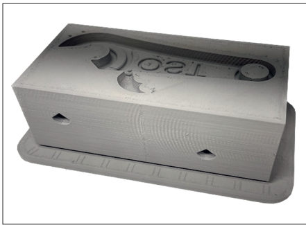
Abb. 2: Formeinsatz vor dem Sinterprozess.
