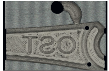
Abb. 9: Oberflächenstruktur von additiv gefertigtem Formeinsatz
