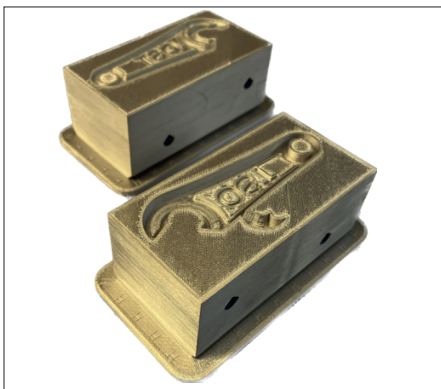
Abb. 3: Formeinsatz nach dem Sinterprozess.
