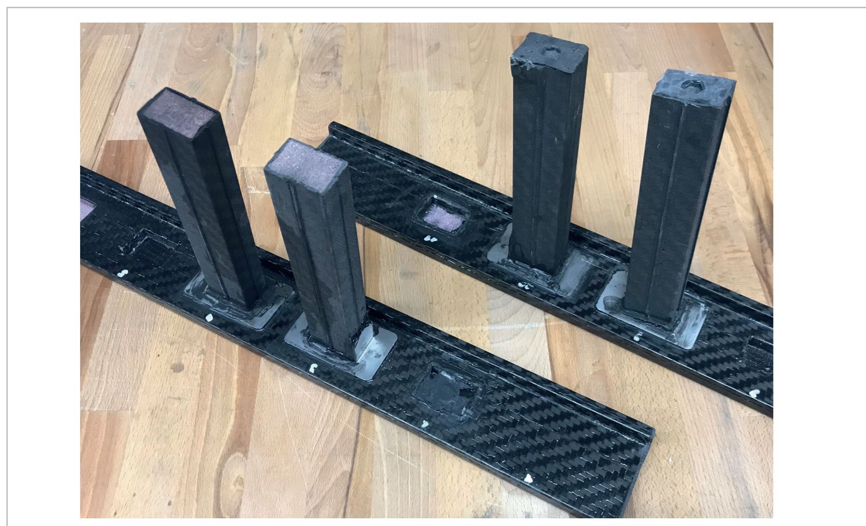
2 | unterschiedlich geklebte Proben zur Ermittlung der Ausreisskraft
