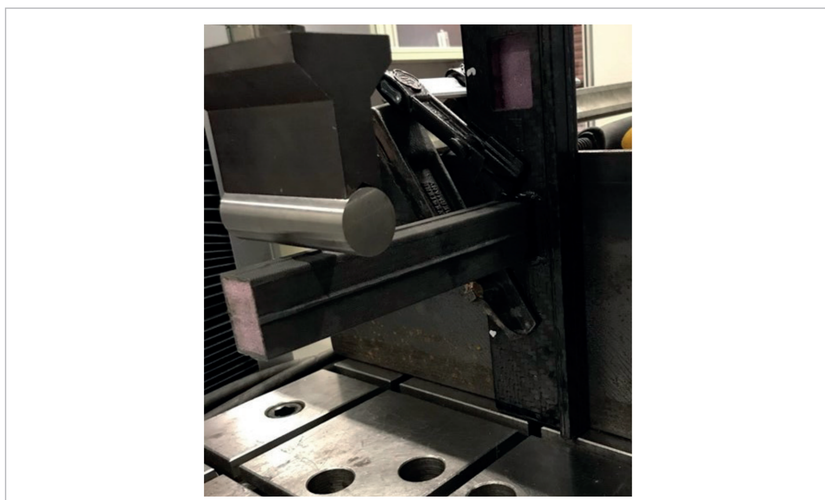
3 | Prüfen der einseitigen Ausreisskraft
