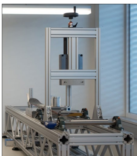
Bild 1: Prüfstand für Steifigkeit und Dämpfungsverhalten (Bilder: IWK)
