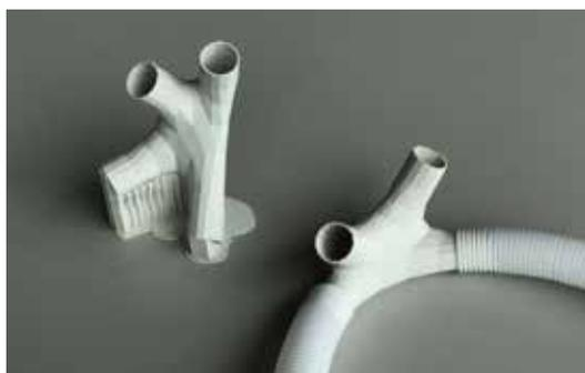
**3D-gedruckte Gussformen** für Betonelemente aus TPU-R.
