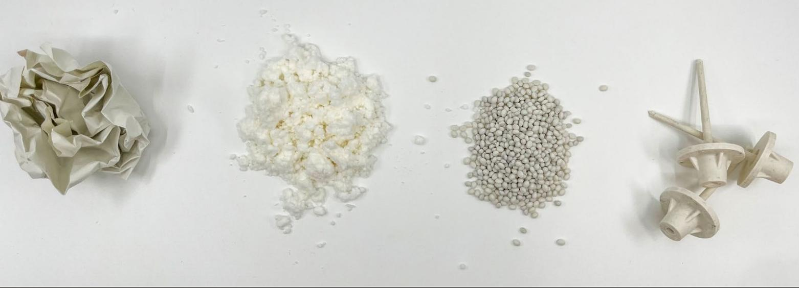
Vom Papier über Pulp und Granulat zum Spritzgussbauteil. (Bilder: IWK)
