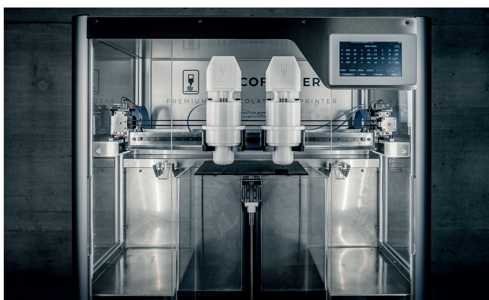
1 | Der optimierte CHOCOFORMER® mit zwei Schokoladen-Druckeinheiten
