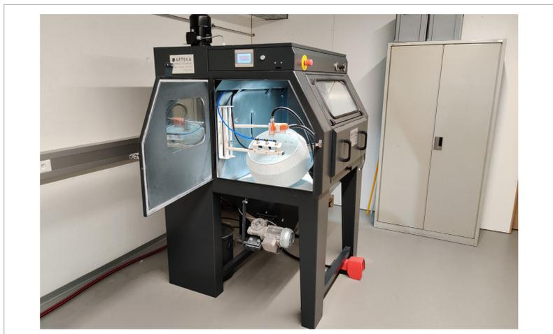
1 | ARTEKA Injektor-Strahlkabine 3D Solid mit Zyklon, Absaugung und automatischer Filterreinigung
