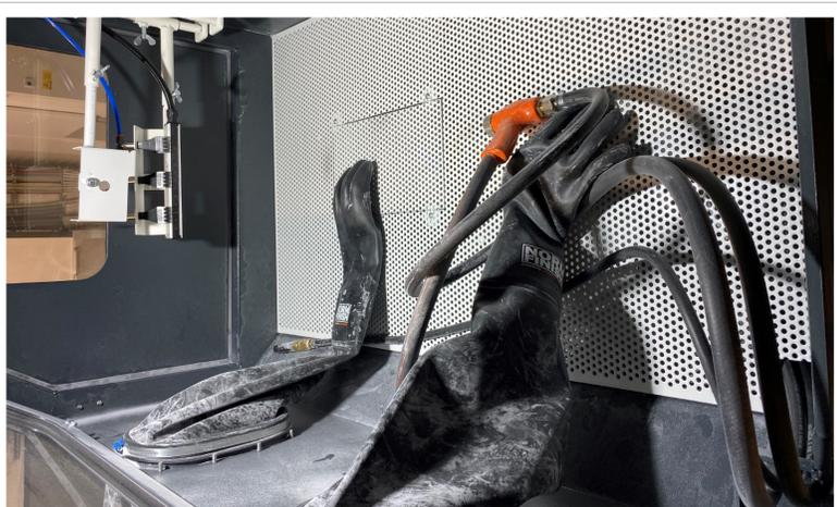
3 | Der Drehkorb kann einfach demontiert werden, so dass die Kabine auch manuell genutzt werden kann
