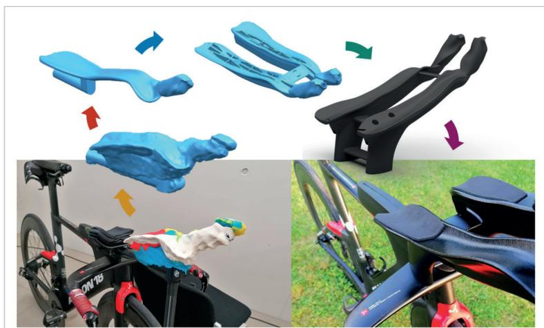
1 | Ermittlung der idealen Lage und Unterarmform mittels Ergonomie-Prototyp und 3D-Scan
