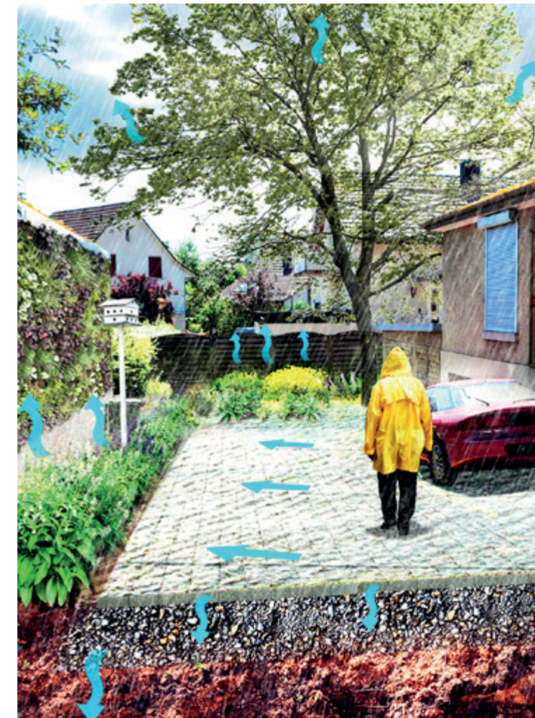
Visualisierung Platzsanierung mit Regenwasserkonzept Quelle: ILF
