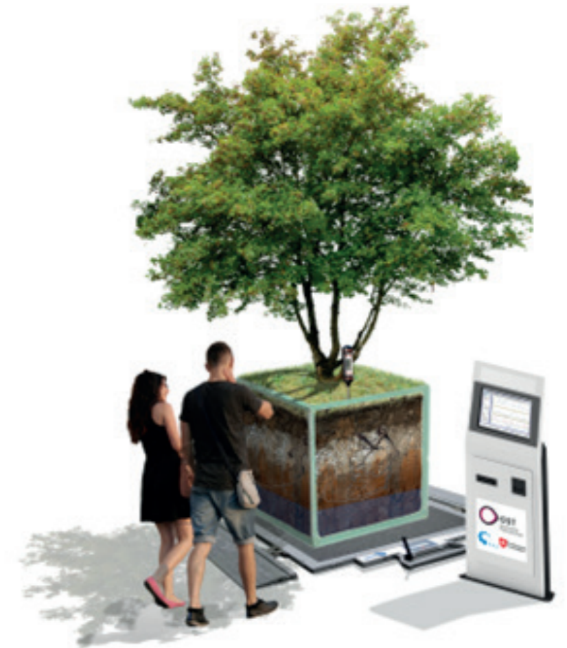
Visualisierung der Baumrigole «Cool Green» Quelle: ILF
