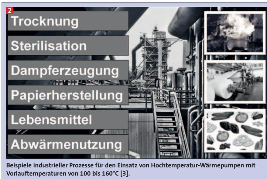
Beispiele industrieller Prozesse für den Einsatz von Hochtemperatur-Wärmepumpen mit Vorlauftemperaturen von 100 bis 160°C [3].
