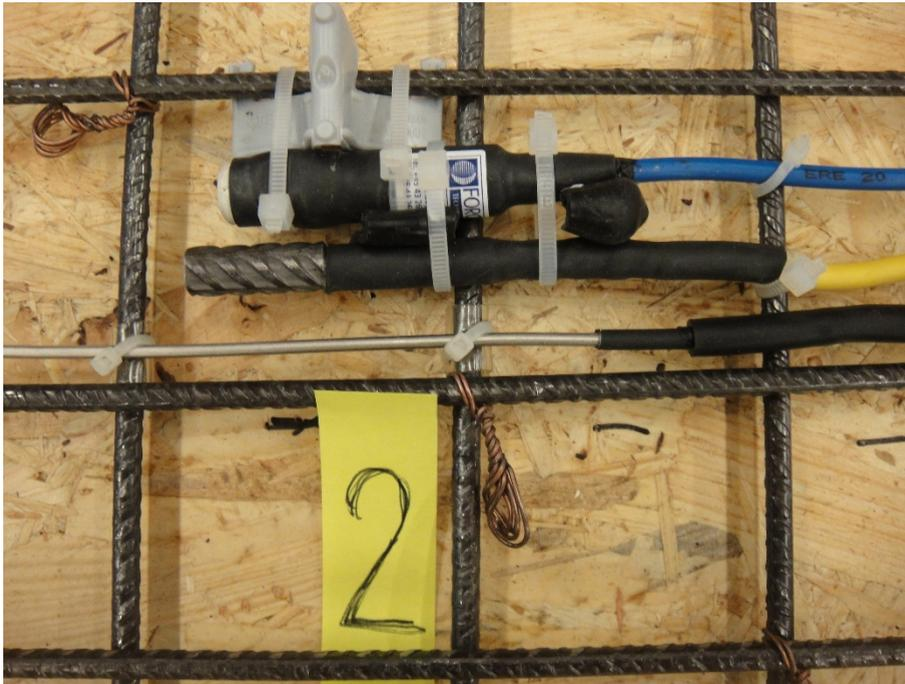
Bild 8: Überwachungssensoren (von oben nach unten: MnO<sub>2</sub>-Bezugselektrode, Messcoupon, Potentialanstiegssensor)
