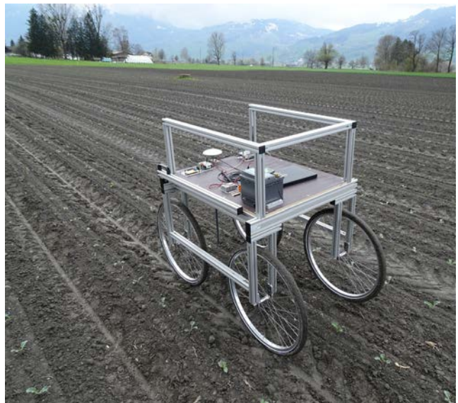
Abbildung 9: Wagen zur Positionsvermessung mittels DGPS
