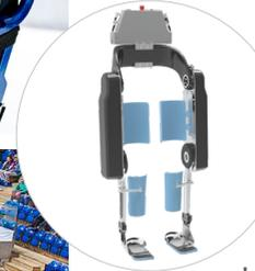
Das VariLeg enhanced ist ein aktives Exoskelett, welches die Hüft- und Kniegelenke der Nutzer mit externen Motoren bewegt und als Rennexoskelet für unsere Piloten Thomas und Rolf entwickelt wurde. Die Paraplegiker können das Gerät über Bedienelemente an der Krücke steuern, wobei jeder Schritt nach Bedarf eingestellt werden kann. So können sie flexibel zwischen verschiedenen Modi wechseln, welche ihnen durch verschiedene Bewegungsmuster die Überwindung von Hindernissen ermöglichen.
