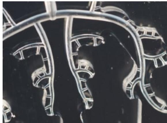
Modulares mikrofluidisches System zur Simulation der koronaren Mikrozirkulation (links) und Bild der Herzkranzgefässe auf dem Chip (rechts).
