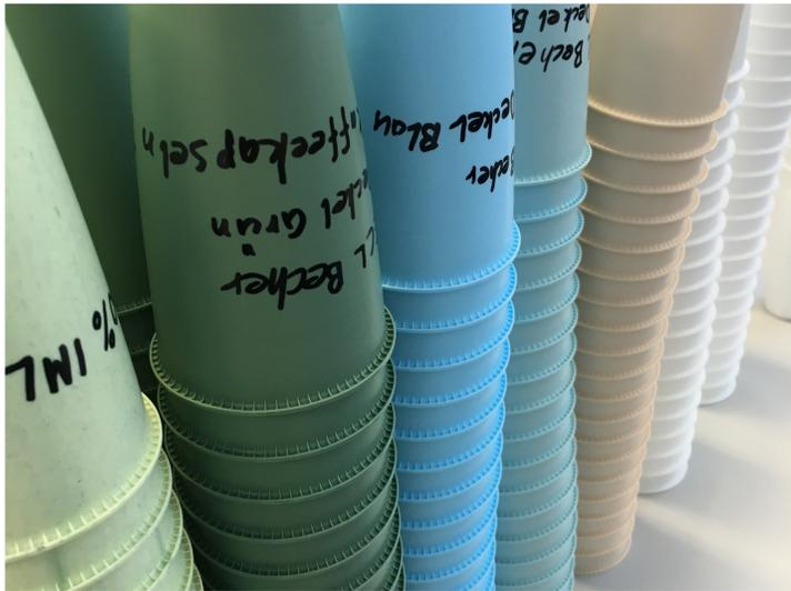
Aus Rezyklat hergestellte PP-Becher. Je nach Farbe der eingesetzten Altkunststoffe resultieren unterschiedliche Farbeffekte im Rezyklat. (Bilder: realcycle/KATZ)
