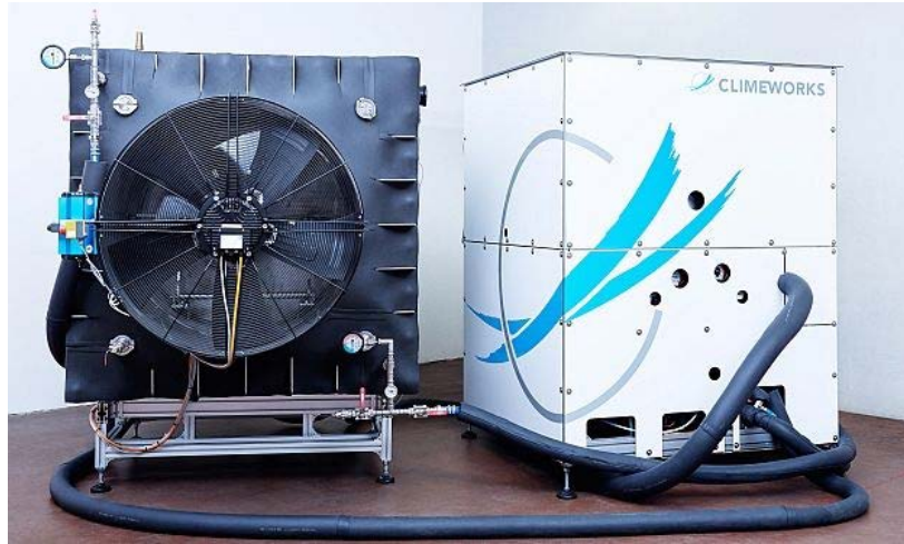
Abbildung 26: Climeworks CO 2 Kollektor mit einer Kapazität von 135 kg/d CO 2 . Die Anzahl Kollektoren kann beliebig erhöht werden bis die gewünschte Adsorptionskapazität erreicht ist. (14)
