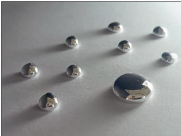
Bei 20°C flüssige Metalllegierungen, welche CO<sub>2</sub> zu C spalten kann. Die Herausforderung besteht darin, die optimalen Prozessbedingungen und Zusammensetzungen für eine industrielle Nutzung zu finden.
