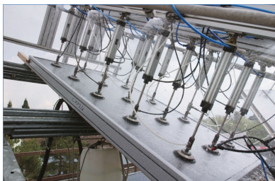
Abb. 1 Belastungstestanlage mit pneumatischen Zylindern. Technisch aufwändig.
