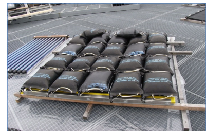
Abb. 3 Belastungstestanlage mit Wasser-/Sandsäcken. Günstig und einfach.
