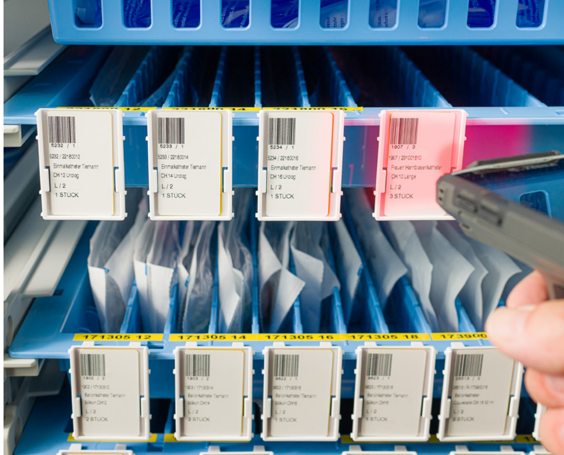
Abbildung 4: Kanban-System: Barcode-scannen bei der Bestellaufnahme
