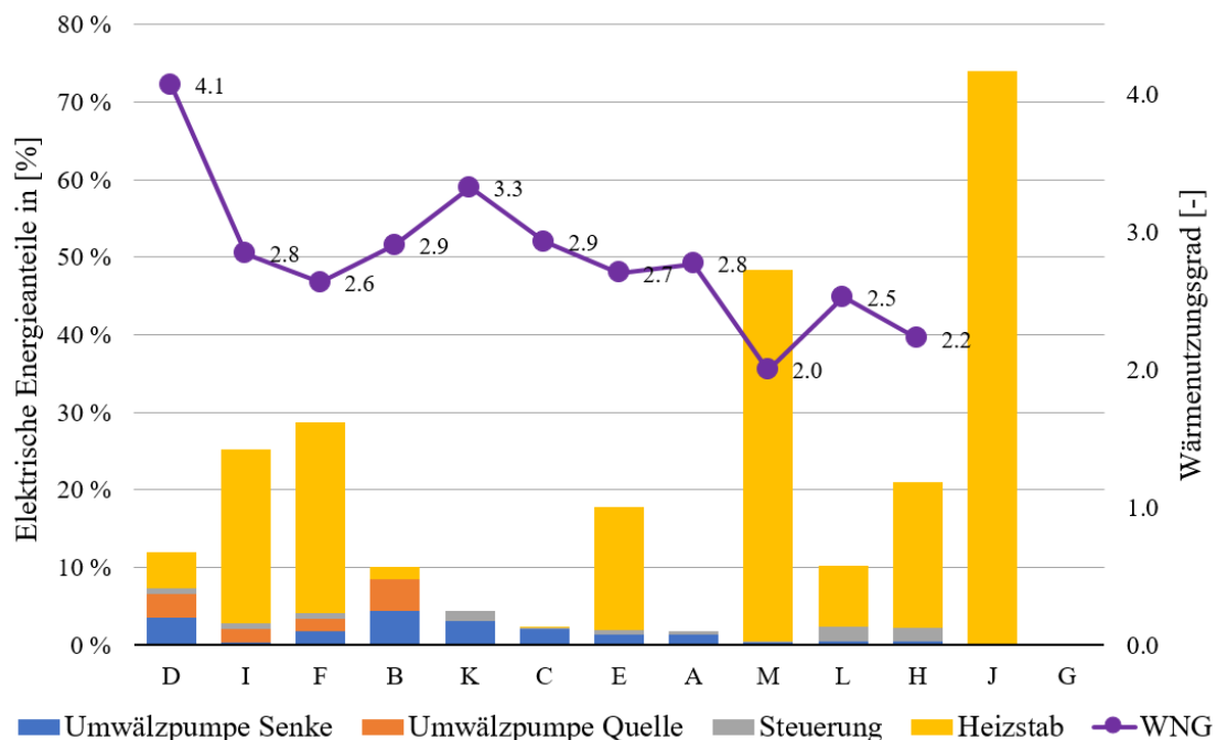
Bild 6: Elektrische Energieanteile der Nebenverbraucher
