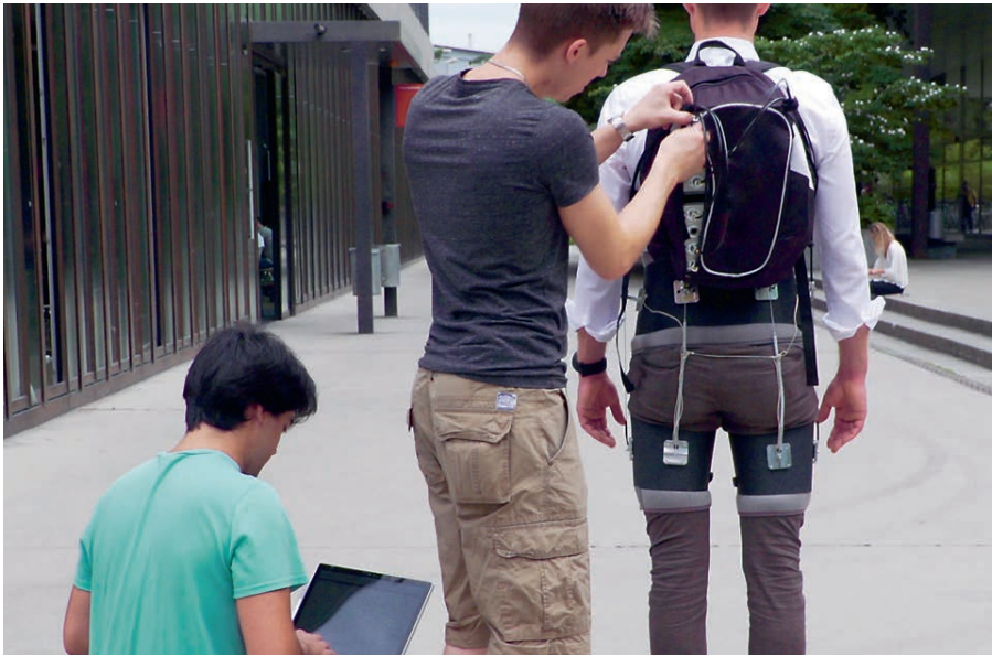
Ein Spezialanzug, der «Exosuit», ermöglicht gehbeeinträchtigten Menschen grössere Bewegungssicherheit.
