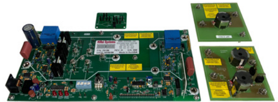
3-in-1: Das neue Multi-Topology-Board mit den Konvertertopologien Buck, Boost und Forward Eigene Darstellung
